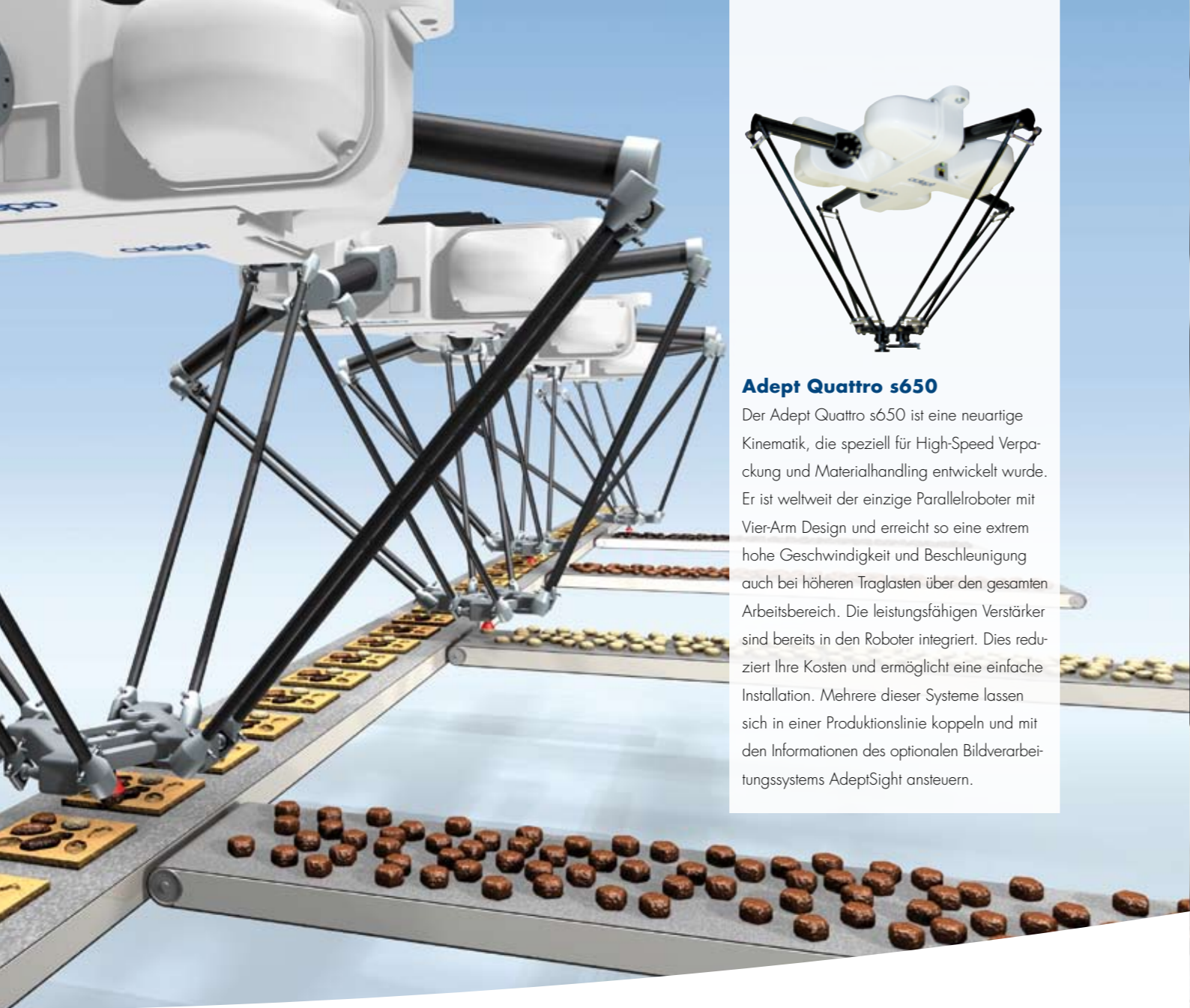
High-Speed Verpackungslinie mit mehreren Adept Quattro s650 Robotern, integrierter Bildverarbeitung AdeptSight und Fließbandverfolgung
