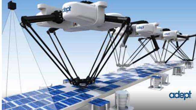
Bild 1: Vier Adept Quattro Roboter mit Bildverarbeitungssystem AdeptSight greifen die einzelnen Solarzellen äußerst schnell vom Förderband ab und legen sie positionsgenau zum Stapeln ab. (Bild Adept Technology)
