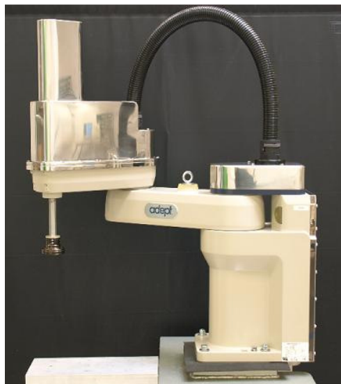
Bild 2: Die Edelstahlroboter SSR 600/800 basieren auf dem Adept Cobra Roboter. Sie verhindern das Ausdringen von Partikeln und das Eindringen aggressiver Reinigungsmedien ins Innere des Roboters.
